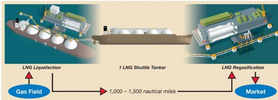
Terminale per la trasformazione del metano precedentemente liquefatto (per comodità di trasporto via nave) in metano gassoso da immettere nei metanodotti terrestri
