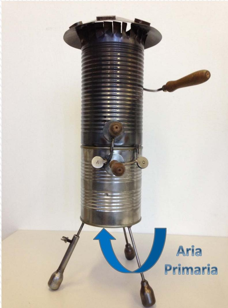
» Inizialmente viene utilizzata aria primaria per “bruciare” biomassa e scaldare il reattore.
